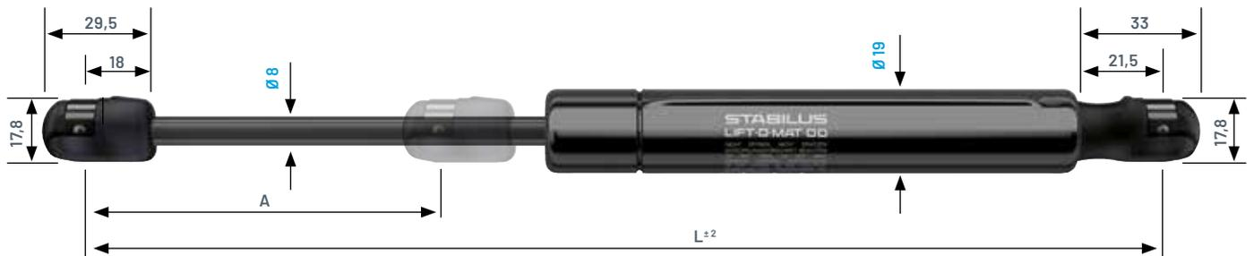
Passend für Kugelzapfen nach DIN 71803 Ø 10
